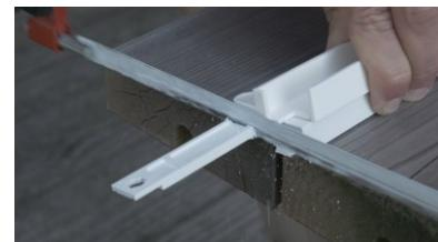
2. Schneiden Sie die überstehende PVC-Stange, die den Betrieb beeinträchtigt, mit einer Säge ab.
