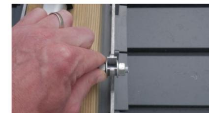
5. Verrouiller les écrous de chaque côté des fourchettes à l'aide d'une clé de 16. Attention, toujours bien maintenir la position fermée des lames.
