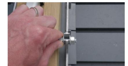
5. Verriegeln Sie die Muttern auf beiden Seiten der Gabeln mit einem 16 mm-Schlüssel. Achten Sie darauf, dass die Lamellenposition geschlossen bleibt.
