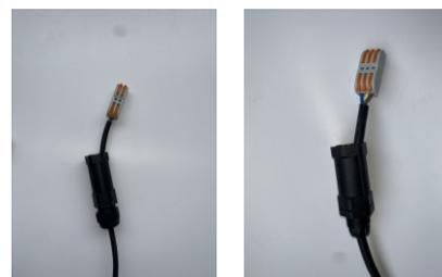
7. Schließen Sie die allgemeine Stromversorgung auf der Seite "Stromversorgung" (3 Drähte: Braun=Phase, Blau=Neutral, Grün/Gelb=Erdung) mit dem mitgelieferten wasserdichten Stecker an. Ein Vertauschen der Drahtfarben oder eine umgekehrte Stromversorgung könnte das Netzteil beschädigen. Öffnen Sie das Gehäuse nicht. Ziehen Sie die Kabelverschraubungen fest, um eine Abdichtung der Anschlüsse zu gewährleisten.
