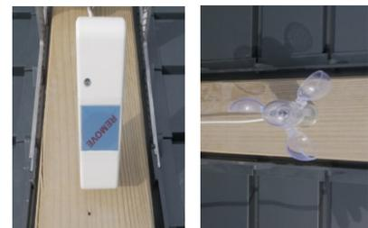
9. (optional) Positionieren Sie die verschiedenen Sensoren (Regen, Temperatur und Wind) an der Struktur. Stellen Sie sicher, dass sie ausreichend exponiert sind, um die gewünschten Wetteränderungen zu erfassen.
