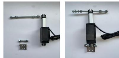
2. Monter le support et l'axe fourchette sur le vérin. (Le vérin doit être rentré, réglage usine). ATTENTION : le vérin va sortir pour ouvrir les lames, le positionner du bon côté des fourchettes.
