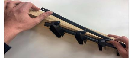
2. Déclipser la tringle PVC des supports de lames à l'aide d'un tournevis. Pour retirer les loquets de verrouillage, s'aider d'une pince.
