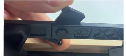
4. Assurer la jonction des tringles aluminium et PVC avec les loquets de verrouillage.
