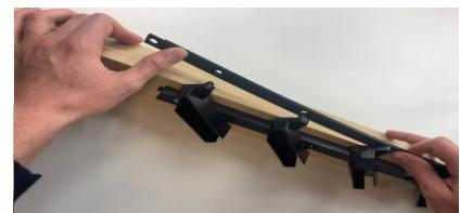
2. Lösen Sie die PVC-Stange mit einem Schrauber von den Lamellenträger. Verwenden Sie eine Zange, um die Stangeverbindungen zu entfernen.
