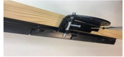
6. Stellen Sie sicher, dass der Riegel in alle Löcher passt, und schrauben Sie die Lochplatine am Pfosten fest.
